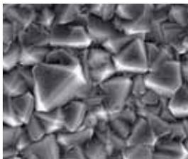
Recubrimiento de diamante de alta dureza (Hv 10,000) proporciona excelente resistencia al desgaste
